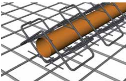
Deckel BASYTUBE V G-150-D verlegen, Rohreinlage seitlich fixieren
