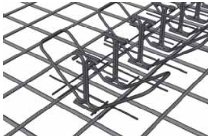
Fuss BASYTUBE T G-e-F verlegen
